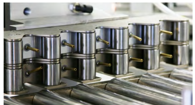
Aluspäne wird von geschliffenen Profilaufgaben weggeblasen
