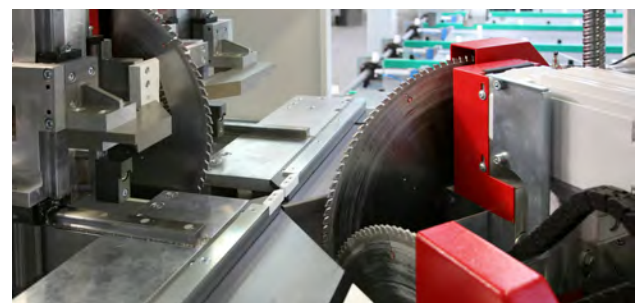
Abbildung: Optima VI Sägenanordnung mit drei Sägeaggregaten
