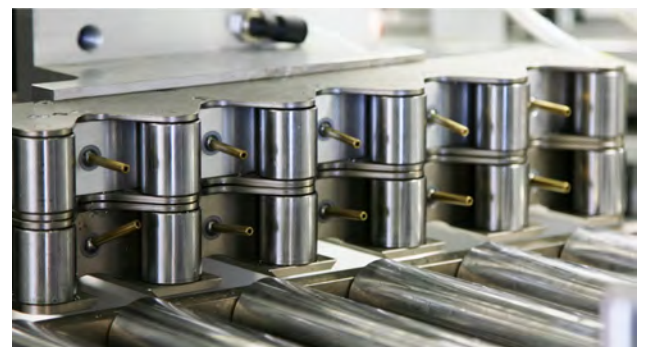
Aluspäne wird von geschliffenen Profilaufgaben weggeblasen
