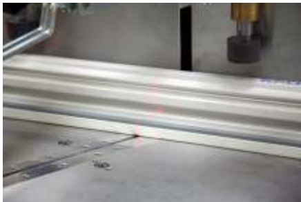
Abb./fig. 2: Laser-Schnittspaltanzeige Viseur laser
